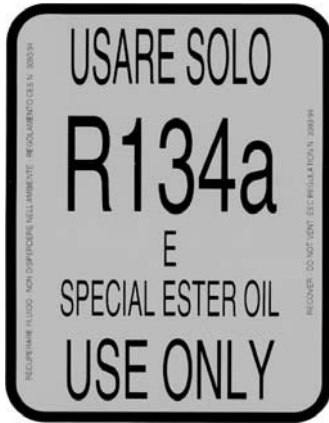
Обозначение типа хладагента (на внешней стороне двери)
