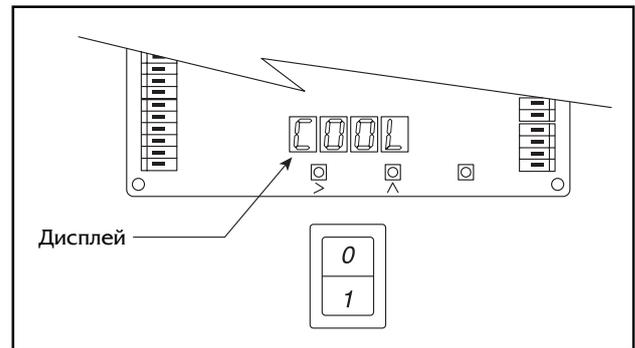
Панель управления контроллера ИЛТС проста в использовании – все сообщения выводятся на 4-х символьный дисплей. Сообщения хорошо видны даже при плохом освещении, т.к. дисплей подсвечивается красными светодиодами.
