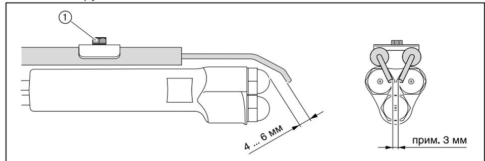
**9.6.2 Настройка электрода зажигания на опорной шайбе**
