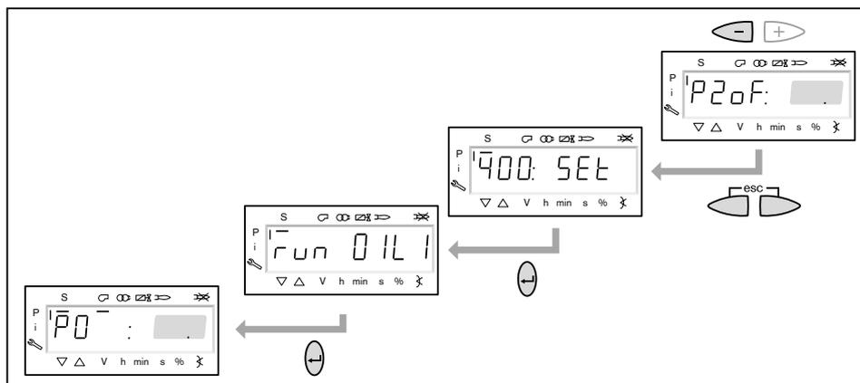
10. Проверка давления смешивания в положении зажигания
