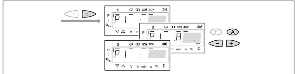
**14. Определение точки подключения P2on**
