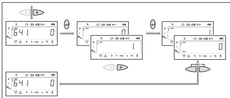
**7. Предварительная настройка точек зажигания и большой нагрузки**
