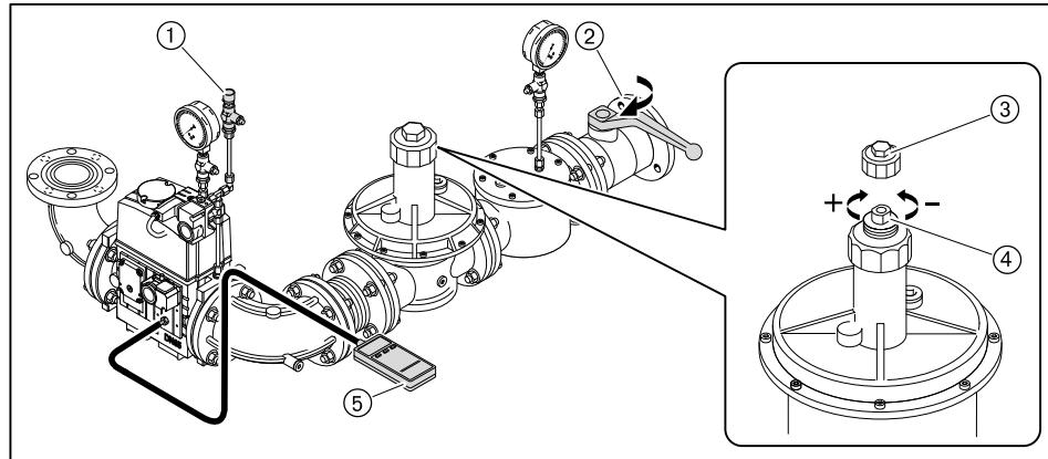
**7.1.8 Предварительная настройка реле давления газа и воздуха**
