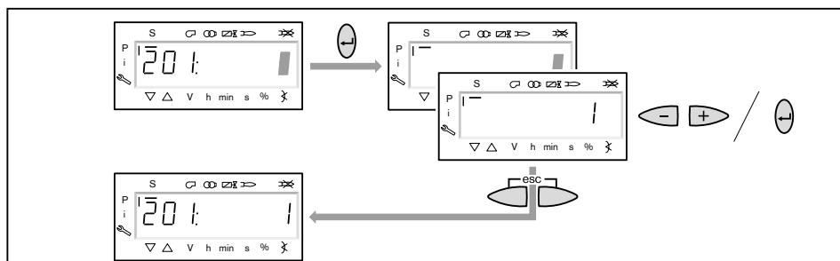
**5. Включение / отключение частотного преобразователя**
