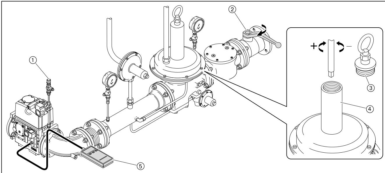
**Предварительная настройка давления на регуляторе низкого давления**
