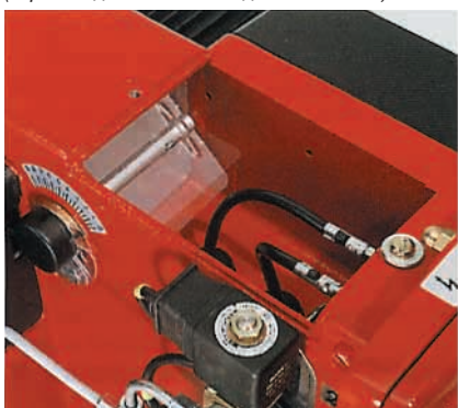
Регулирование воздуха со стороны напора
