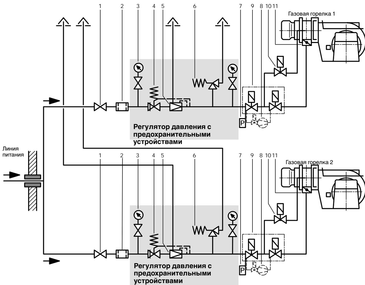
Каждая горелка имеет регулятор давления с предохранительными устройствами, выполненными согласно рабочей документации DVGW G 490.
