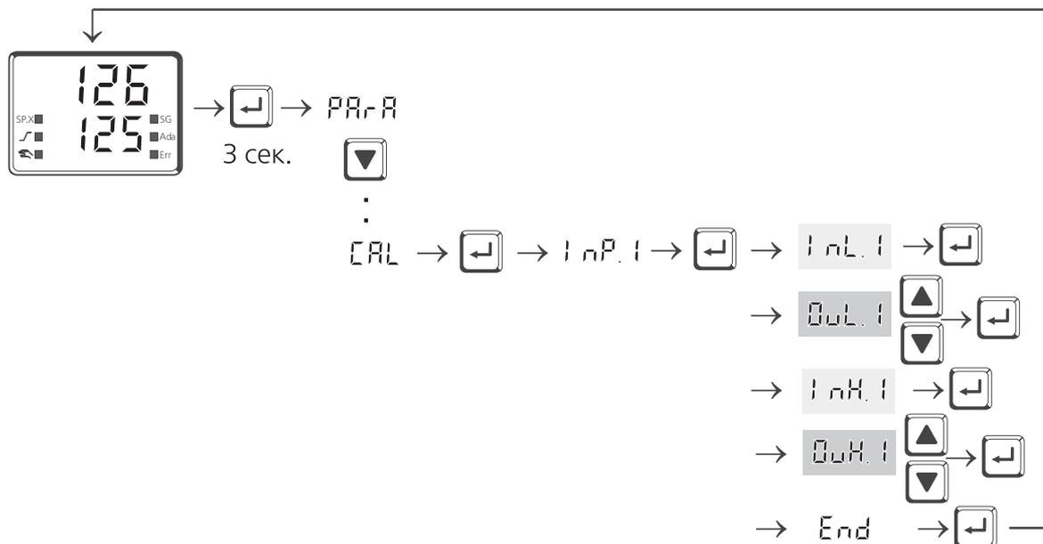
**InL.1 :** Здесь выводится входной параметр нижней точки шкалы. С помощью датчика фактических значений пользователь должен произвести настройку нижнего входного параметра и затем подтвердить данный параметр нажатием кнопки
