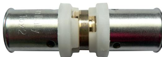
посадки трубы в фитинг. Уплотнение обеспечено двумя специальными уплотнительными кольцами. Для обжатия можно использовать пресс-клещи „ТН“ или „В“.
