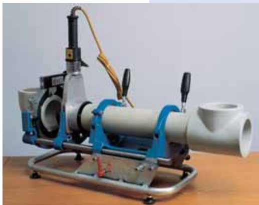
закрепление в аппарате и центровка, потом нагрев
