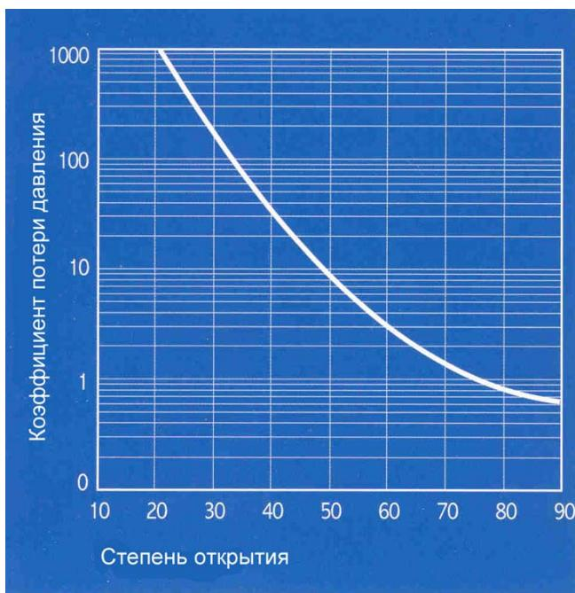
Коэффициент потерь давления на дисковом затворе в зависимости от степени открытия позволяет определить потери давления при определенной скорости потока:
