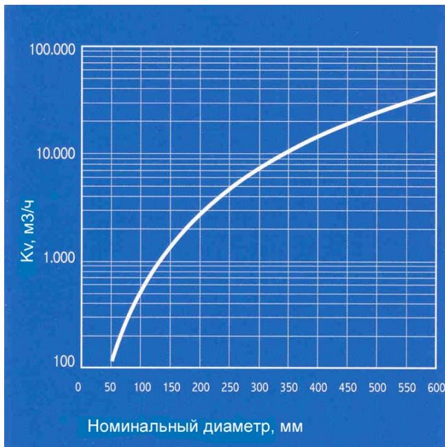
Пропускная способность  $K_v$  полностью зависит от  $D_u$  и позволяет определить для соответствующих значений расхода потерь давления на затворе.
