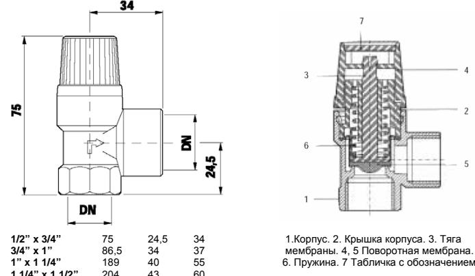
Предохранительные клапаны серии SVH могут применяться в системах, работающих на теплоносителе, содержащим этиленгликоль, процентное содержание которого не должно превышать 50%. Эксплуатация возможна при условии применения теплоносителя, специально разработанного для систем отопления.
