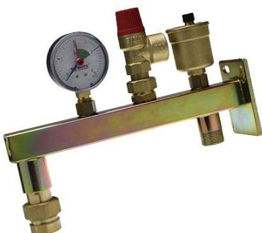
Для защиты отопительной системы и крепления мембранных баков. Состоит из автоматического воздуховодчика MV10R, предохранительного клапана SVH 30, манометра MHR 63/4 с запорным клапаном и консоли с присоединительной арматурой Fixflex SK20, которая позволяет опорожнять бак для демонтажа без опорожнения системы.
