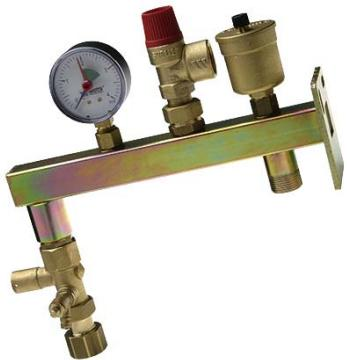
Для защиты отопительной системы и крепления мембранных баков. Состоит из автоматического воздуховодчика MV10R, предохранительного клапана SVH 30, манометра MHR 63/4 с запорным клапаном и консоли с присоединительной арматурой KAV 20, которая позволяет опорожнять бак для демонтажа, без опорожнения системы, а также имеет возможность опечатывания бака и может быть снабжена комплектом пломбировочных печатей.
