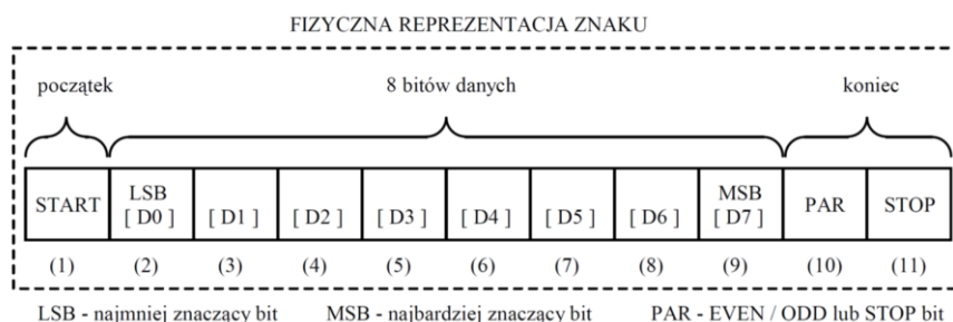
Рис. 7. Символьный формат MODBUS RTU, используется в преобразователе стандартно.
