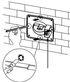
14. Просверлить 4 отверстия в стене, забить дюбели, прикрепить оголовок к стене с помощью 4-х винтов:
