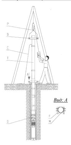
Точка подвески (P) для подъемного механизма и несущий трос на агрегате должны быть расположены так, чтобы агрегат опускался точно по центру колодца или скважины и при этом висел точно вертикально.
