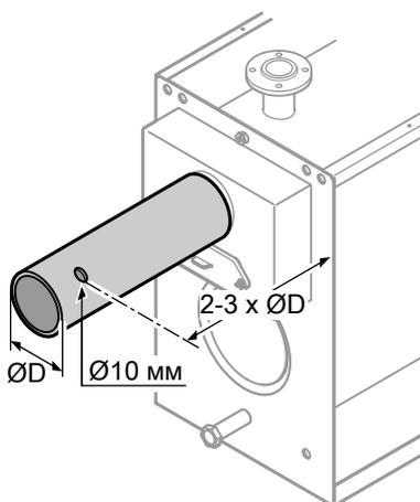
1. Соединить патрубок уходящих газов с дымоходом кратчайшим путем и с небольшим подъемом. Наружный  $\varnothing$  патрубка уходящих газов:
