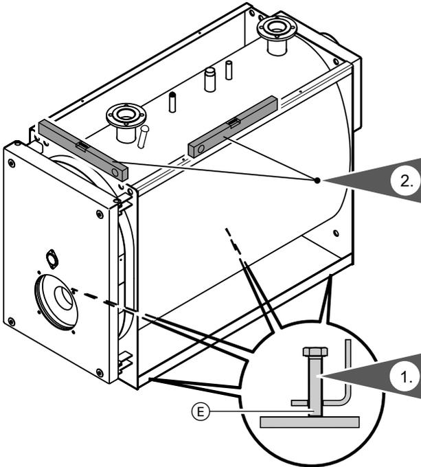
1. Ввинтить регулировочные винты (E) в шины основания.
