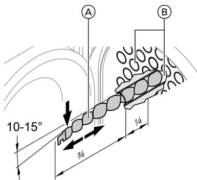
1. Задвинуть турбулизаторы (A) примерно на  $\frac{1}{4}$  длины в газоходы (B).
