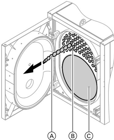
1. Вынуть турбулизаторы (A), не применяя силы; при этом использовать имеющееся в комплекте поставки приспособление для извлечения турбулизаторов.
