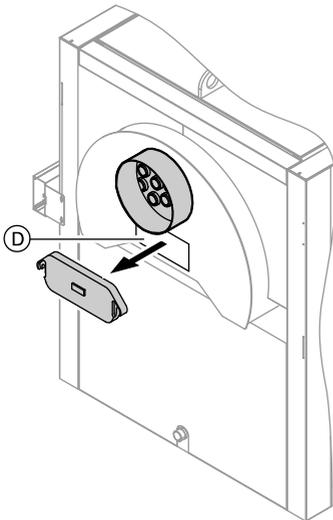
3. Удалить пылесосом остаточные продукты сгорания из дымохода и сборника уходящих газов через отверстие для чистки в сборнике уходящих газов (D).
