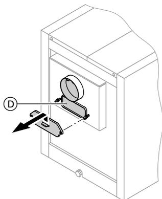
3. Удалить пылесосом остаточные продукты сгорания из дымохода и сборника уходящих газов через отверстие для чистки в сборнике уходящих газов (D).
