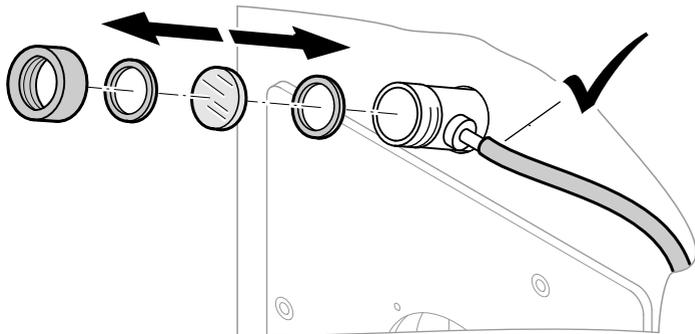
Проверить герметичность уплотнений и шлангового соединения.
