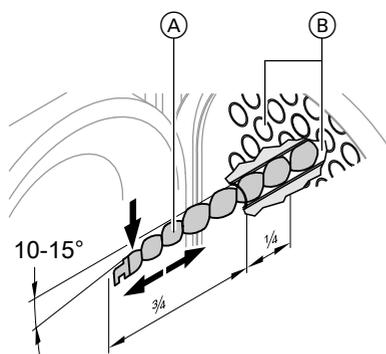
1. Вставить турбулизаторы (A) примерно на  $\frac{1}{4}$  длины в газоходы (B).
