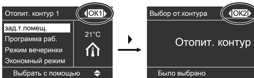
Отопительные/охлаждающие контуры обозначаются изготовителем "Отопит. контур 1" (OK1), "Отопит. контур 2" (OK2), "Отопит. контур 3" (OK3), а отдельный охлаждающий контур - "Контур охлажд. SKK" (SKK).
