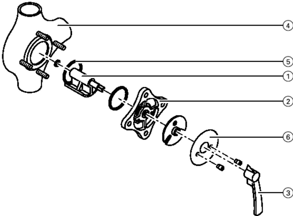
1. Раскрутить четыре гайки и вынуть наконечник смесителя ① с крышкой ② и ручкой смесителя ③
