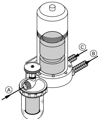
(A) Подводящий топливопровод от резервуара
