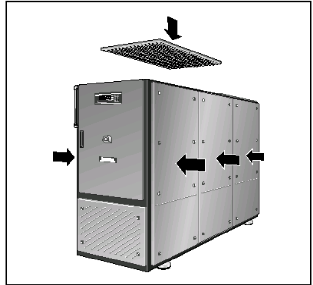
Рис. 13 Монтаж элементов шумопоглощающего кожуха
