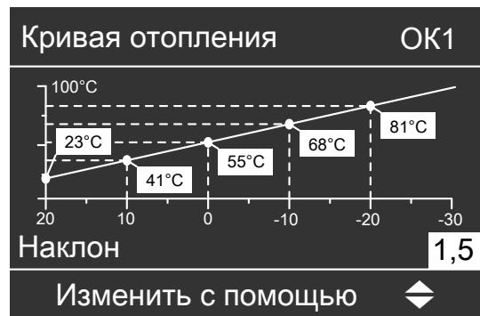
В зависимости от различных значений температуры окружающей среды (изображены по горизонтальной оси) соответствующие заданные значения температуры подачи для отопительного контура изображаются на белом фоне.
