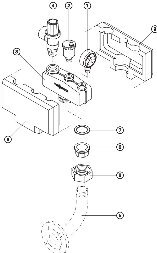
1. Свободно смонтированные детали прочно привинтить, чтобы обеспечить уплотнение резьбы уплотнительными кольцами.
