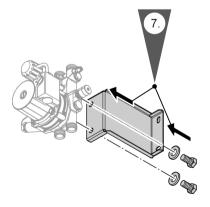
7. Закрепить консоль на корпусе смесителя к стене с помощью прилагаемых винтов и подкладных шайб.
