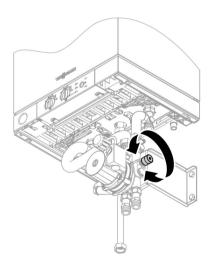
В отопительный контур со смесителем встроен байпас. В состоянии при поставке байпас закрыт. При необходимости для минимизации пиков температуры открыть байпас (повернуть против часовой стрелки).
