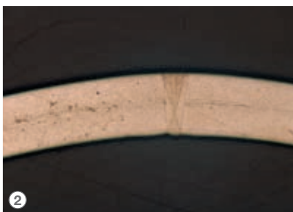
2 Узкий лазерный сварной шов Viega.
