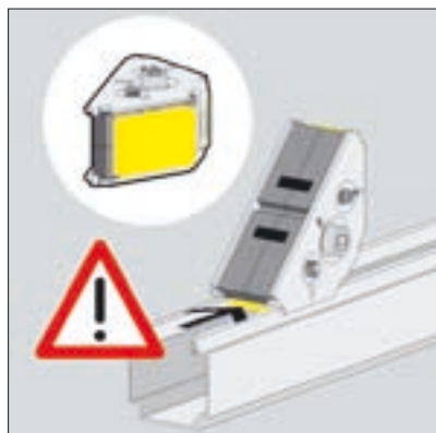
Короткая сторона соединителя Steptec с открытой стороны профиля.
