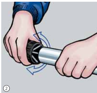
2 Снять грат изнутри и снаружи трубы.
