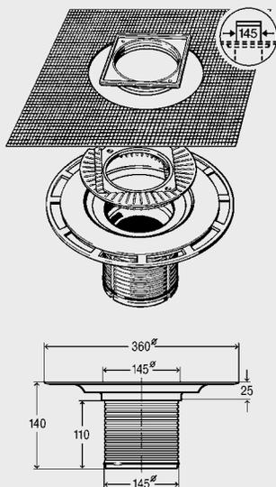
**Advantix Plus, дополнительная насадка,** из пластмассы, с эксцентриковой регулируемой до 15 мм в каждую сторону рамкой из нержавеющей стали, с регулировкой по высоте до 20 мм, с уплотнительной манжетой Schluter-KERDI для шпаклёвочной или промазочной изоляции, модель 4994.1
