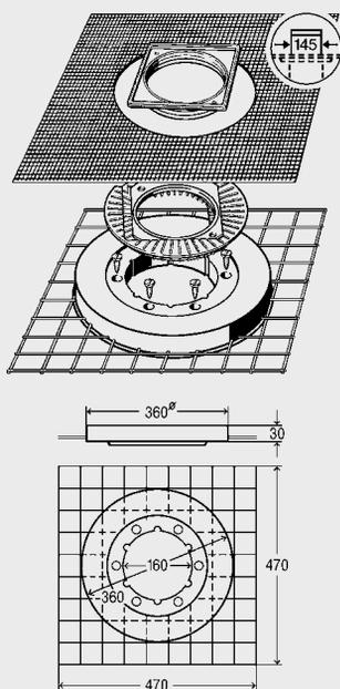
**Advantix Plus, изолирующий фланец,** из полимербетона, с эксцентриковой регулируемой до 15 мм в каждую сторону рамкой из нержавеющей стали, с регулировкой по высоте до 20 мм, с формованным бетонным матом и дополнительной манжетой из стеклоткани для прикручивания к трапу или насадке (арт. 285128), для шпаклёвочной или промазочной изоляции (например, KERDI), модель 4954.1
