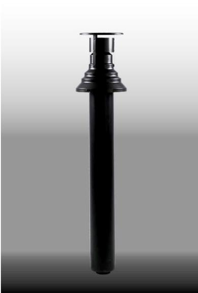
**Рис. № 19** Дымовая труба для установки через крыши трубы концентрической  $\varnothing 60/100$ , потеря давления: 21 Па
