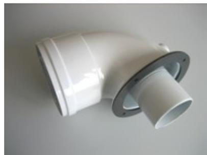
**Рис. № 24** Колено  $\varnothing 60/100/93^\circ$  с фланцем  $\varnothing 125$  мм, потеря давления: 1,5 Па
