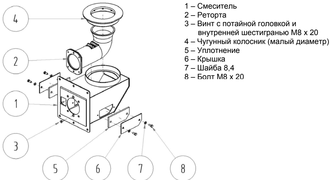
Рис.№ 4 Горелка со смесителем (топливо – бурый и каменный уголь)
