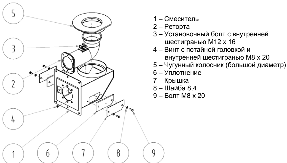
Рис. № 5 Горелка со смесителем (топливо – древесные гранулы)
