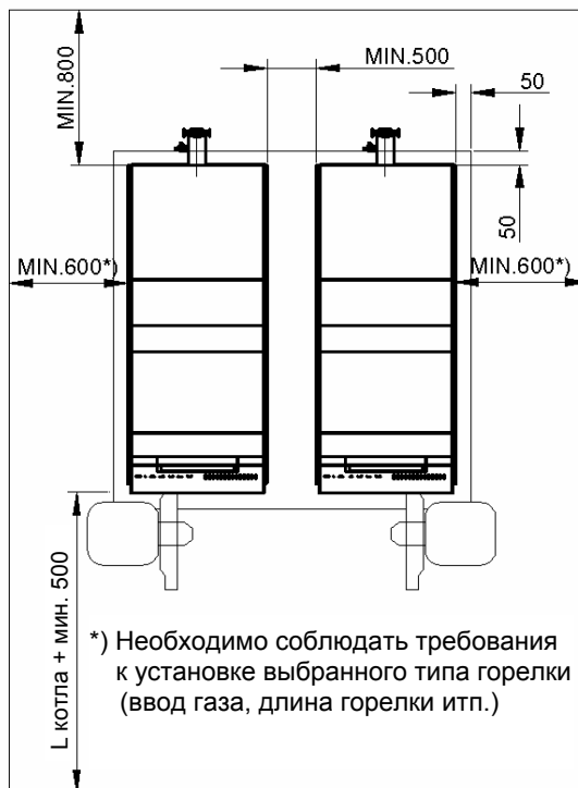
Рис.№ 2 Расположение котла G 300 в котельной
