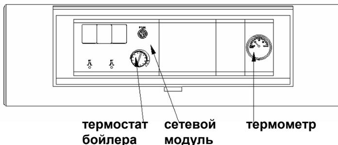
**Рис. 4** Панель управления бойлером VIADRUS OV 100 L
