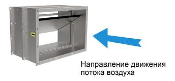
$V_1$  - вылет лопатки за габарит корпуса, мм.  $V_1$ =2·B/(3·N)-200 (при отрицательных значениях вылет отсутствует). Вылет лопатки возможен только со стороны  $V_1$ . N - кол-во лопаток в клапане, шт.
