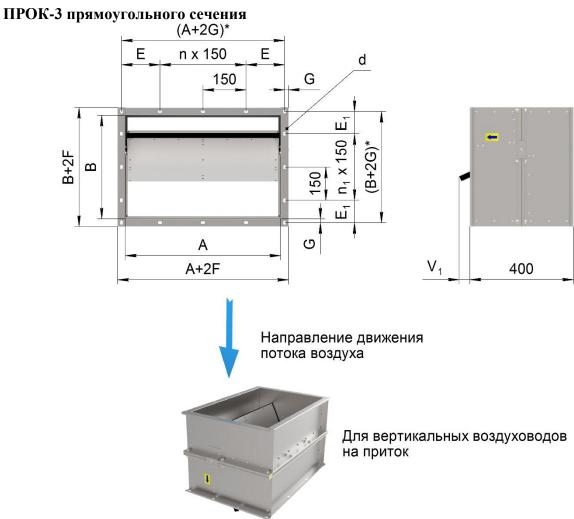
$V_1$  - вылет лопатки за габарит корпуса, мм.  $V_1$ =2·B/(3·N)-200 (при отрицательных значениях вылет отсутствует). Вылет лопатки возможен только со стороны V<sub>1</sub>. N - кол-во лопаток в клапане, шт.
