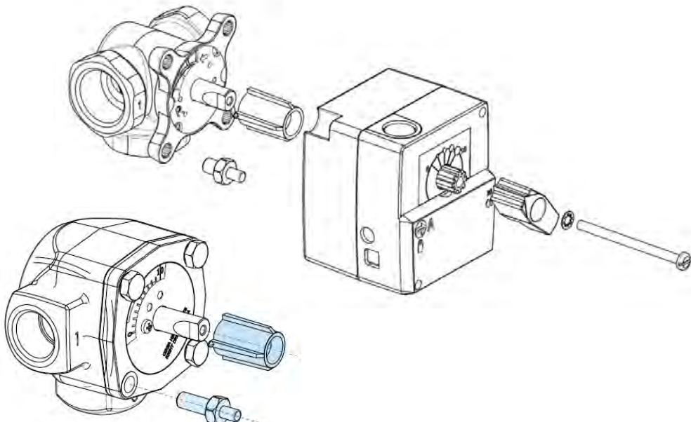
1. Ställ ventilen i nolläge, kontrollera hur ventilen öppnar (öppning medurs = höger, öppning moturs = vänster) Ta av handtaget från shuntventilen.
