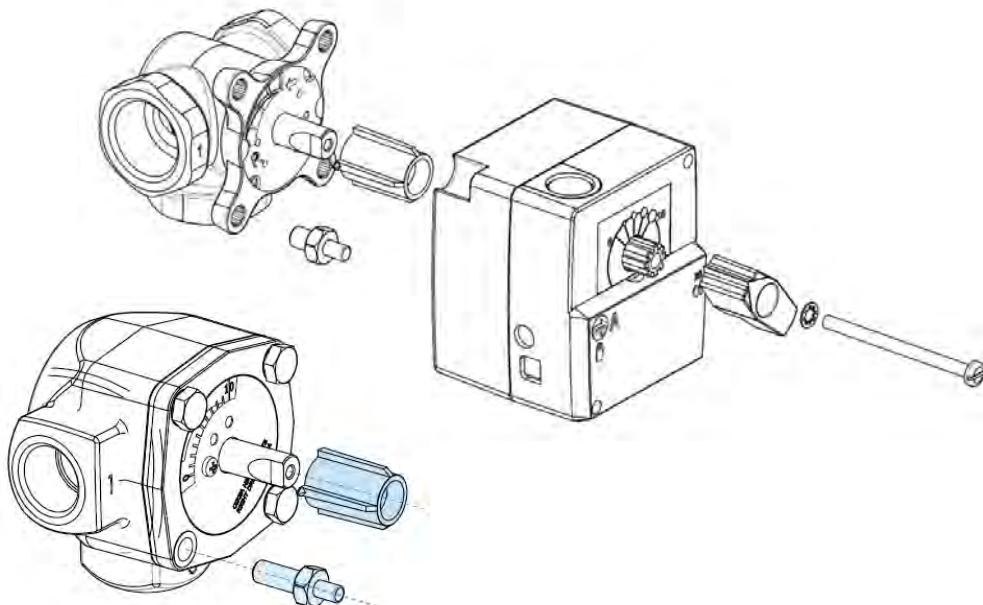
1. Die Drehrichtung des Mischers prüfen. Nach Werkseinstellung öffnet sich der Mischer im Uhrzeigersinn.
