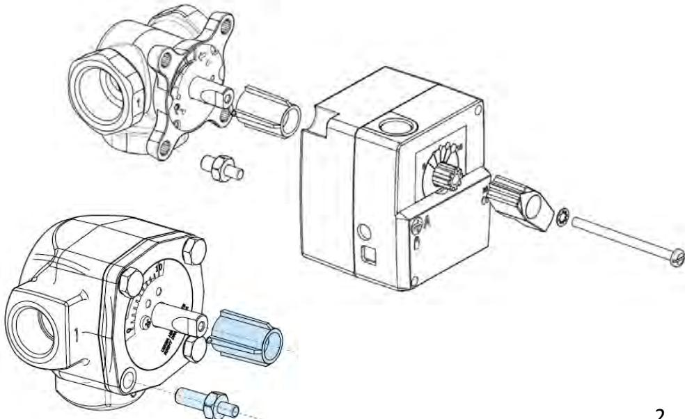
1. Tarkista venttiilin käisyys, oletuksena on oikeakäytinen venttiili eli venttiili avautuu myötäpäivään käänämällä.
