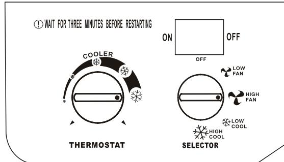
Управление кондиционером осуществляется при помощи ручек режима работы (Selector) и термостата (Thermostat), расположенных на панели управления.
