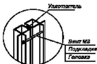
Подсоединение вентиляционных каналов
