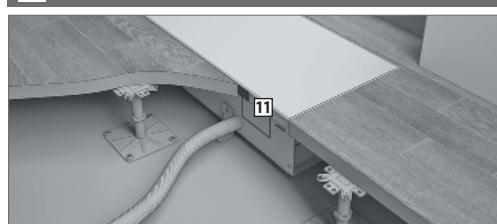
**10 МОНТАЖ ПОЛОВОГО ПОКРЫТИЯ И УСТАНОВКА ДЕКОРАТИВНОЙ РЕШЕТКИ**
