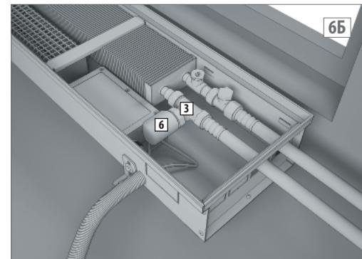
**7 МОНТАЖ ВЕНТИЛЕЙ И ПОДВОД ТРУБ**
