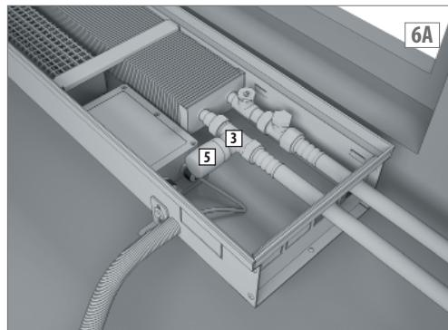
**6А Схема с ручным регулированием.**
