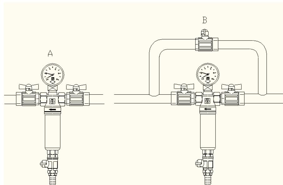
6.4. Муфтовые соединения должны выполнять с использованием в качестве уплотнительных материалов ФУМ (фторопластовый уплотнительный материал), сантехнической полиамидной нити и льна.
