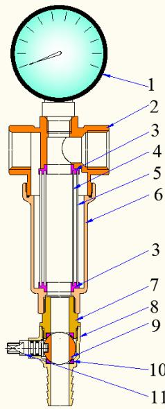
Фильтр состоит из корпуса 2 и колбы 6, выполненных из горячештампованной латуни CW617N с гальваническим покрытием из никеля. Между собой корпус и колба соединены на резьбе с кольцевой прокладкой из EPDM.
