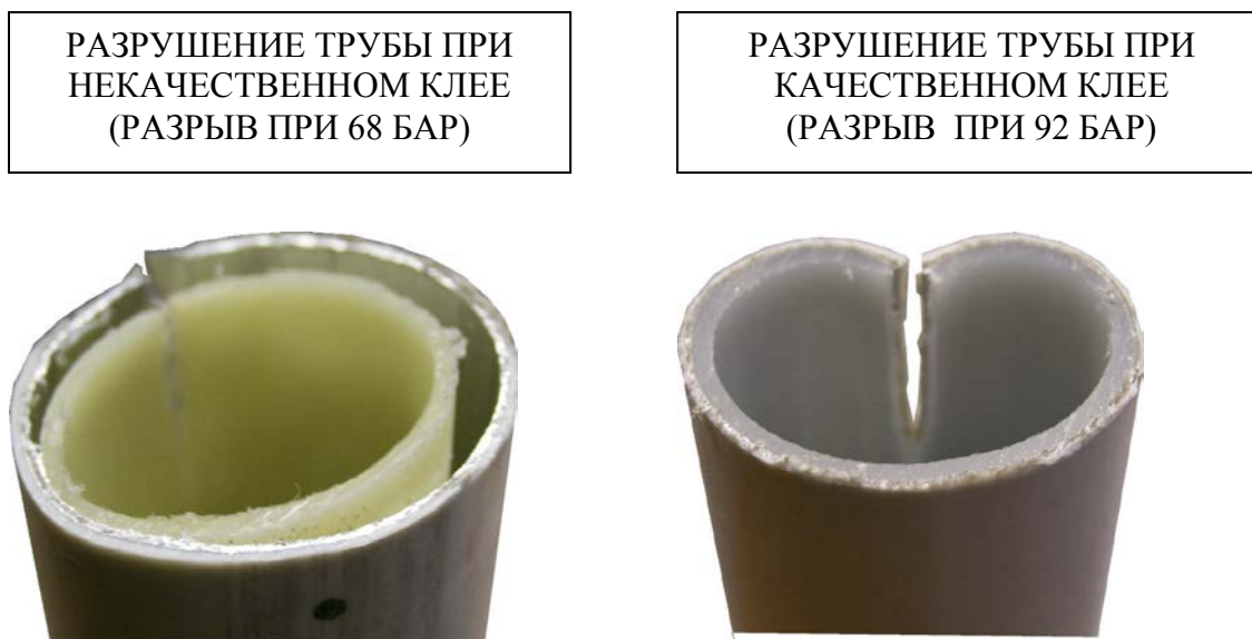
Рис.2.3.4.р.2 Вид среза МПТ после разрывных испытаний
