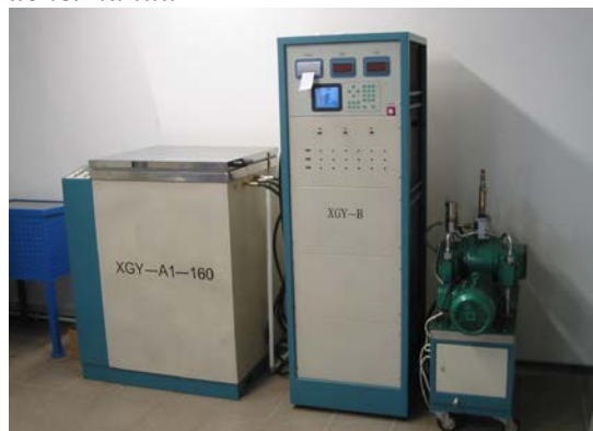
Рис.2.4.3.р.3 Стенд статических испытаний МПТ
