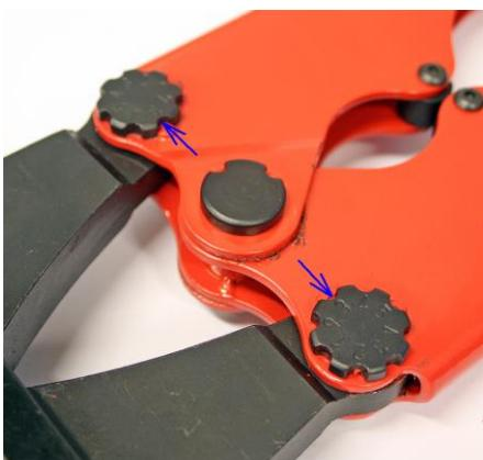
4.2. В случае, когда зазор между полуобоймами при сомкнутых рукоятках более 2мм, следует переставить эксцентрики на меньшее значение по шкале. Для этого следует развернуть рукоятки инструмента примерно на 30°, и открутить самоконтрящиеся гайки эксцентриков. Не рекомендуется устанавливать разные значения на эксцентриках. После установки эксцентрика в требуемое положение, гайки следует установить на место и затянуть.
