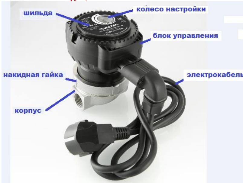
**3.1.** Циркуляционный насос представляет собой электронасос с однофазным асинхронным электродвигателем со сферическим статором и сферическим «мокрым» ферромагнитным ротором с интегрированным рабочим колесом.
