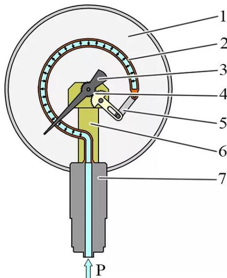
Основу прибора составляет медная изогнутая пружинная трубка овального сечения (трубка Бурдона) (поз.2). Рабочая среда поступает через присоединительный штуцер 7, выполненный из латуни CW614N, в трубку Бурдона. Под воздействием давления рабочей среды пружинная трубка меняет свою геометрию. Изменение положение заглушки трубки Бурдона по тяге 5 передается через трибно-секторный механизм 4 на ось стрелки 3, которая занимает соответствующее положение на шкале 1.
