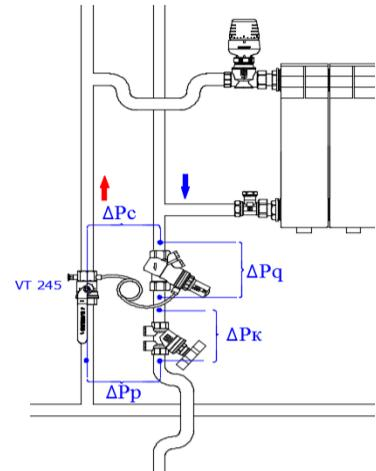
Импульсная трубка подключается к шаровому крану VT.245, установленному на подающем стояке. Балансировочный клапан размещается на обратном стояке после регулировочного клапана. Схема применяется в случаях, когда радиаторы снабжены термостатическими клапанами с преднастройкой, или когда на выходе из радиаторов установлены настроечные клапаны. Повышенное (по сравнению со схемами 1 и 2) давление в радиаторах снижает вероятность завоздушивания.
