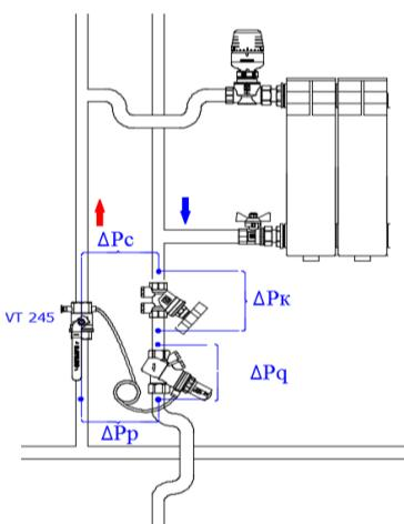
Импульсная трубка подключается к шаровому крану VT.245, установленному на подающем стояке. Балансировочный клапан размещается на обратном стояке до регулировочного клапана. Схема применяется в случаях, когда арматура предварительной настройки на радиаторах отсутствует.
