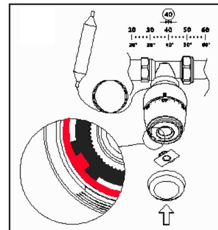
6.4. После указанных манипуляций следует установить на место фиксирующую планку «c» (до щелчка) и надеть крышку корпуса «b».
