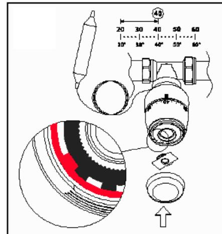
6.3. Для фиксации настройки необходимо установить верхнее стопорное кольцо таким образом, чтобы «зуб» корпуса расположился между «зубами» стопорного кольца. В таком положении получается жестко зафиксированное значение настройки.
