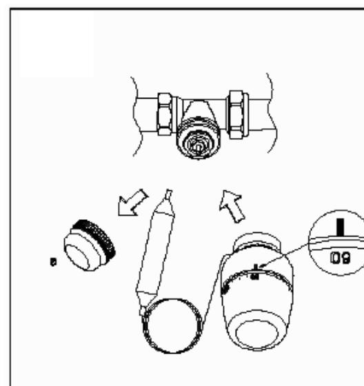
4.1. Термостатическая головка должна использоваться совместно с термостатическими клапанами, выполненными по стандарту HD 1215-2 Part2 и EN 215-1 part1 .
