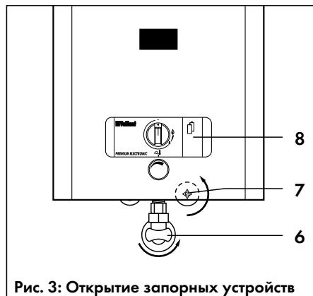
Рис. 3: Открытие запорных устройств
