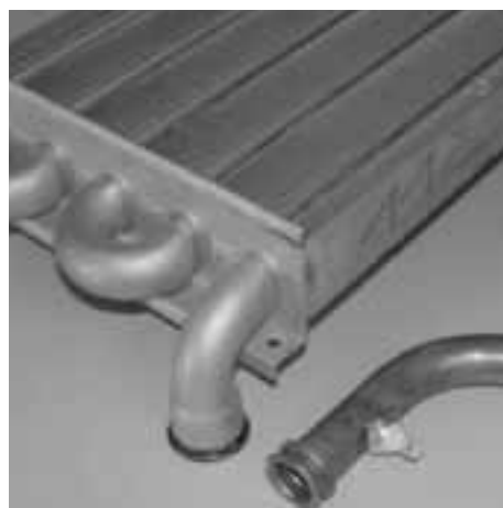
Новый теплообменник с трубкой с датчика. Штуцер на теплообменнике удалён.
