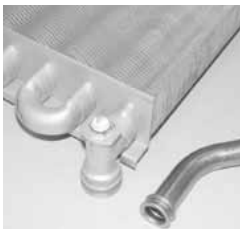
Старый теплообменник с трубкой без датчика. Датчик—в штуцере теплообменника.
