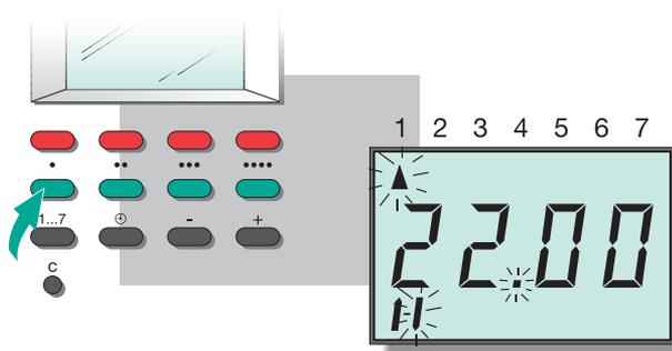
**2** Нажать первую зелёную кнопку. Показано программируемое время выключения (22:00), правый столбик для времени выключения первого временного отрезка для отопительного контура мигает.
