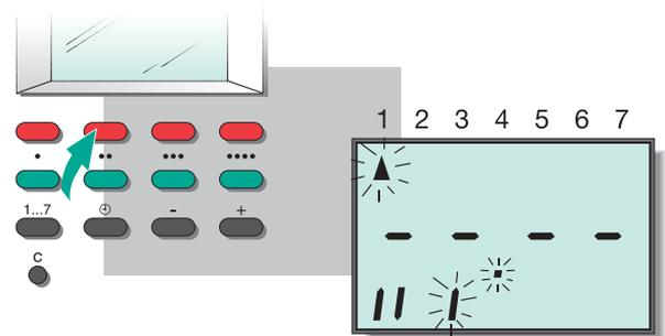
**4** Нажать вторую красную кнопку. Замигает левый столбик для времени включения второго временного отрезка. Так как до сих пор второй временной отрезок не использовался, время не отображается (--:--).
