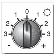
Поворотная ручка установки "дневной" температуры в помещении (Ручка **4** в описании прибора) находится в положении "0". В этом основном положении при полностью открытых термостатных вентилях в помещении достигается температура 20°C. При этом предполагается, что соответствующая отопительная кривая установлена корректно. (см. Часть 7.1). Каждое деление шкалы означает изменение температуры на 2,5°C.
