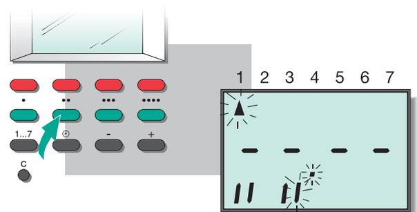
**6** Нажать вторую зелёную кнопку. Замигает правый столбик для времени выключения второго временного отрезка. Так как до сих пор второй временной отрезок не использовался, время не отображается (--:--).
