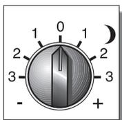
Поворотная ручка установки "ночной" температуры в помещении (**3**) находится в положении "0". В этом основном положении в ночное время (имеется ввиду период отопления с пониженной температурой) в помещении достигается температура 10°C. Каждое деление шкалы означает изменение температуры на 2,5°C.
