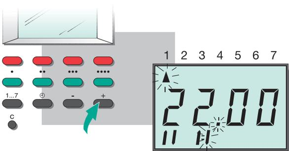
**7** Нажимать кнопку "+" до тех пор, пока не появится желаемое время (22:00). Вы создали второй временной отрезок для работы отопительного контура в понедельник, но внесённые изменения ещё не сохранены!
