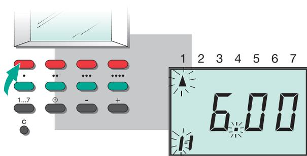
**2** Нажать первую красную кнопку. Замигает левый столбик - первый момент включения отопительного контура. Установленный момент включения отображается цифрами (здесь 6:00).
