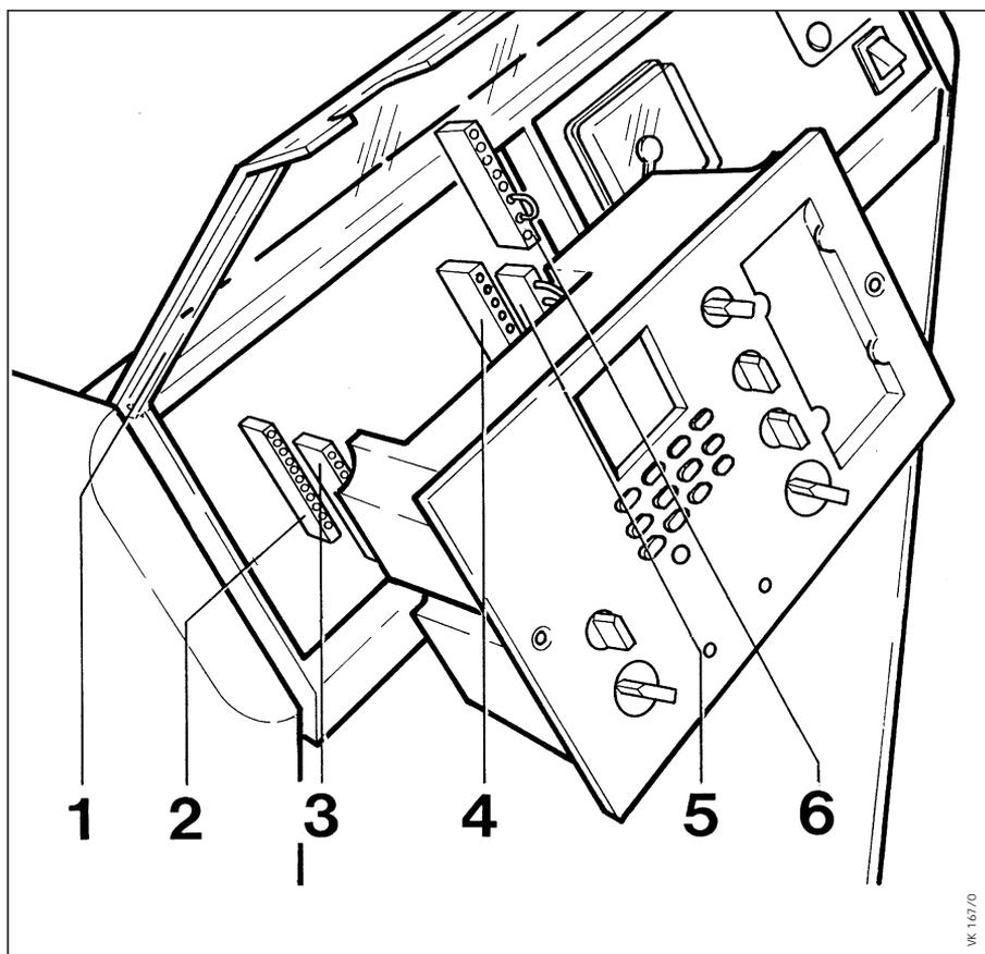
Рис. 3.1 Монтаж регулятора в панель управления котла
