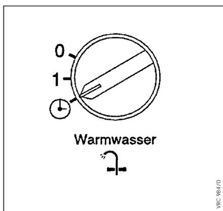
Рис. 5.4 Переключатель режимов работы приготовления горячей воды
