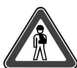
**Ohrozenie života úderom elektrického prúdu na prívodných častiach vedúcich elektrické napätie. Pred prácami na zariadení je potrebné odpojiť ho od prívodu elektrickej energie a zaistit' pred opäťovným zapnutím.**
